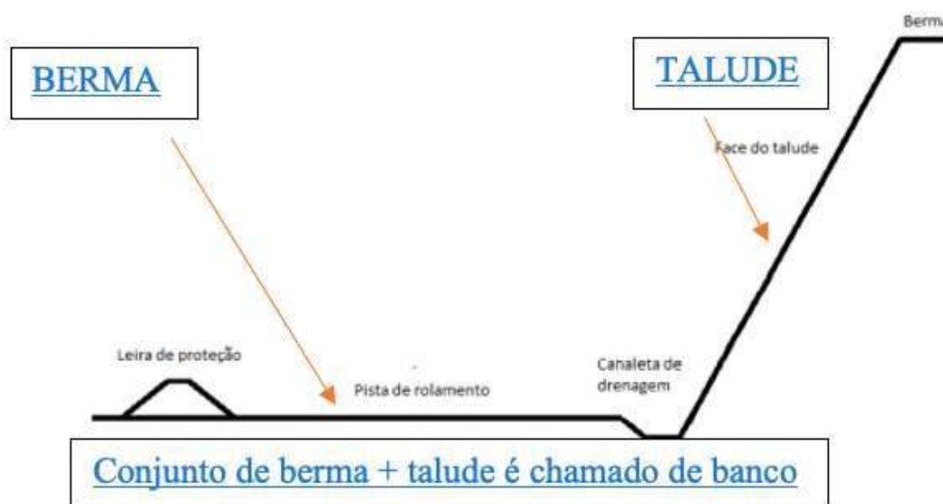
Figura 39 Perfil construtivo esquemático do talude
